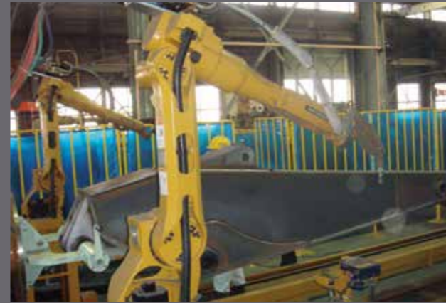
▲溶接ロボット
